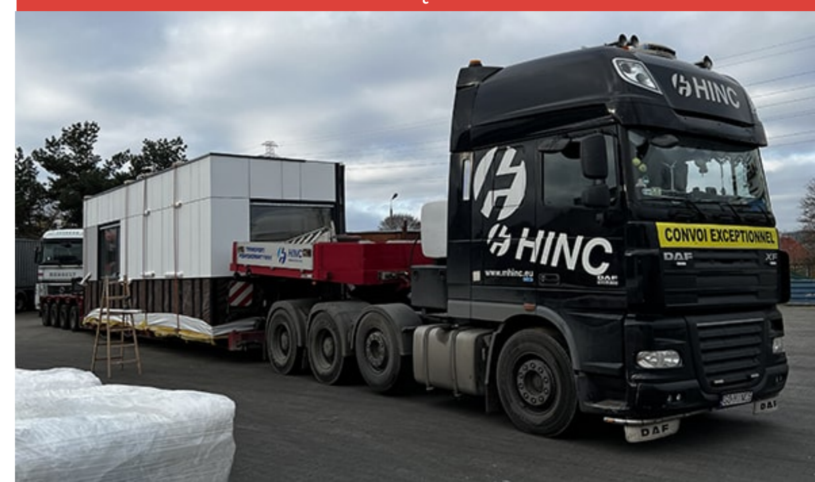
Transport domu modułowego na działkę
